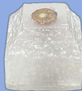
2.切片: 使用LEICA SM 2000R滑走式切片机进行切片，**刀片架角度5°**。将试样固定在切片机试样夹上，借助水平仪调整试样切面成水平面，右手拉动滑动轴，左手用毛笔接片并置于载玻片上。如切片易破损，无法完整成片，可配置**聚苯乙烯泡沫溶液**用毛刷涂抹至试样切面表面，待干燥后再进行切片。
